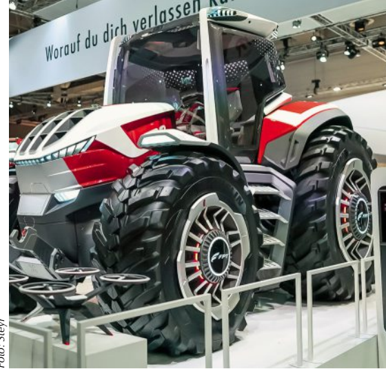
Eine Konzeptstudie: Dieselmotor unter der Haube, E-Motoren in den Radnaben.
