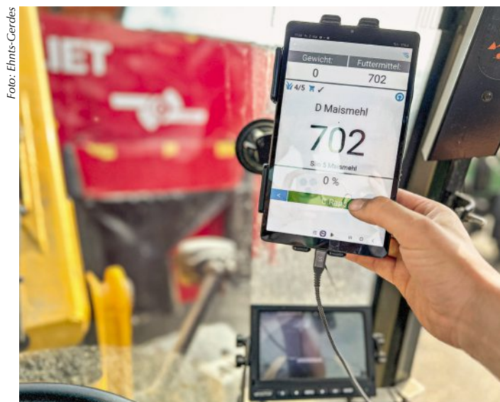
Für die Zusammenstellung der Vormischung zieht sich der Futtermischwagen die Daten aus der Fütterungs-App.
