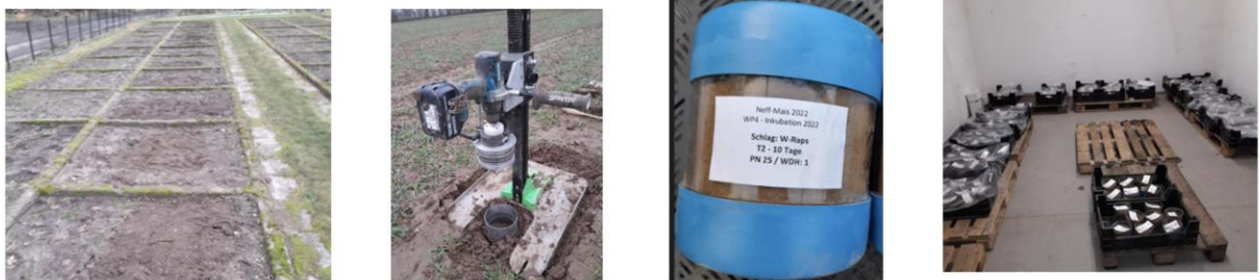
Abbildung 35 Beispielhafte Darstellung eines Probenahmestandortes mit Versuchspartzen, Entnahmegerät, verschlossener und ungestörter Bodenprobe sowie inkubierten Proben im Labor (von links nach rechts).
